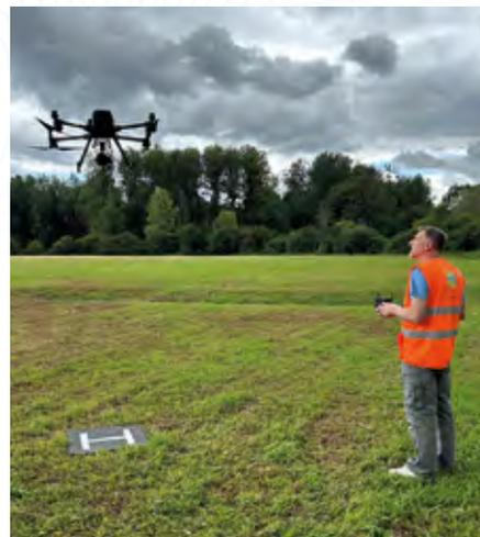
Le **drone basé sur le LiDar\*** permet à la fois de mieux comprendre les phénomènes d'écoulements en cas de ruissellement, d'effectuer de la photogrammétrie des berges, la topographie des cours d'eau, et d'inspecter des ouvrages... Cet outil permet d'obtenir des données topographiques précises du terrain naturel, de photographier et de filmer. Une équipe d'ingénieurs de l'En-
