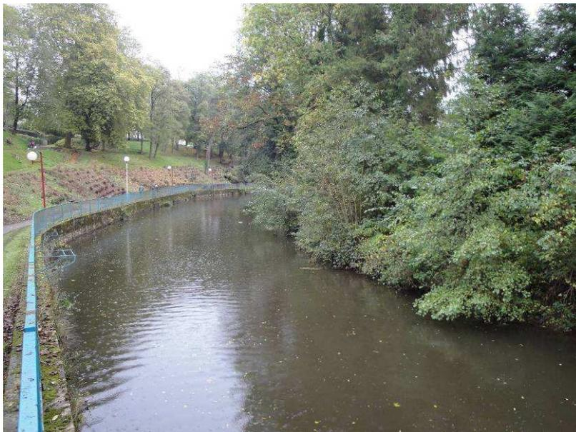
**Figure 32 : Exemple de berges naturelles en rive gauche et artificielles en rive droite**
