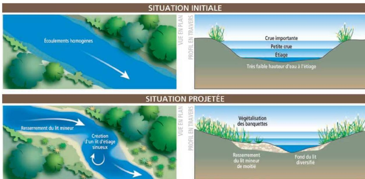
**Figure 63 : Modification schématique de la géométrie du lit mineur**
