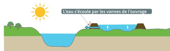
**4** Le niveau de l'Oise est suffisamment bas pour que le risque inondation soit écarté. Les vannes de vidange, situées dans la digue, sont ouvertes et l'eau peut s'écouler gravitairement.
