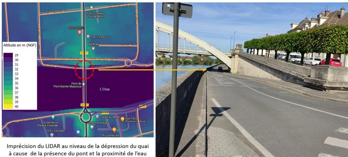
Imprecision du LIDAR au niveau de la dépression du quai à cause de la présence du pont et la proximité de l'eau
