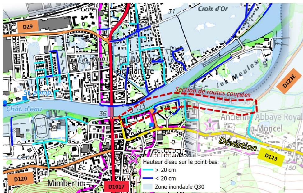
Figure 46: Impact de la crue Q30 sur les principales voiries de Pont-Sainte-Maxence
