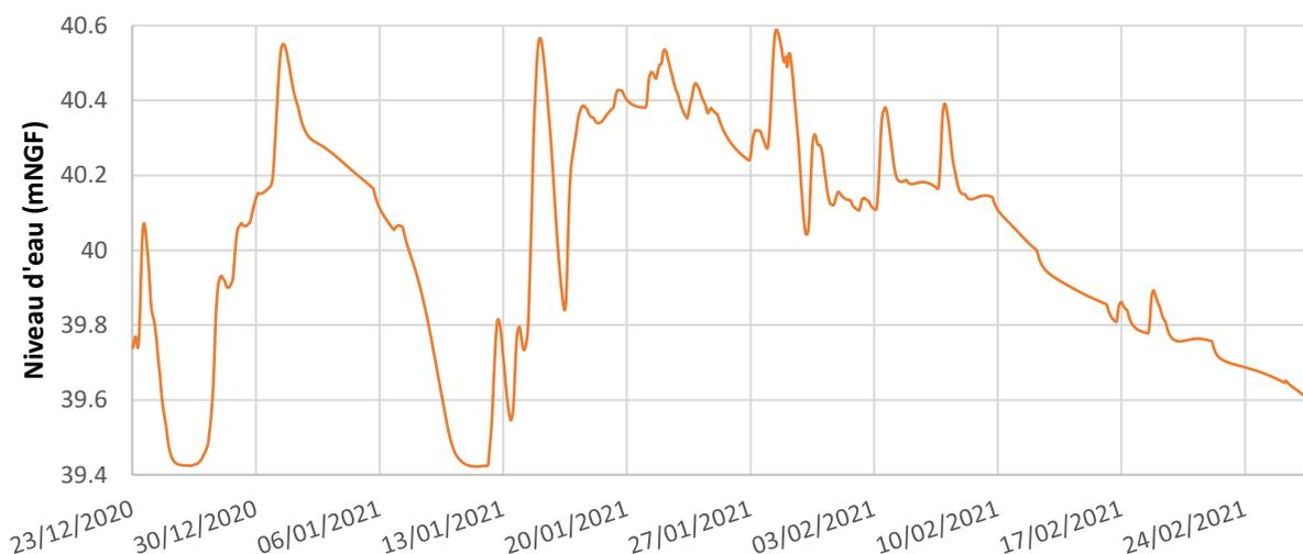
Figure 8 : Hydrogramme des niveaux d'eau simulé à Appilly pour la crue de 2021 avec le calage réalisé sur la crue de 2020.
