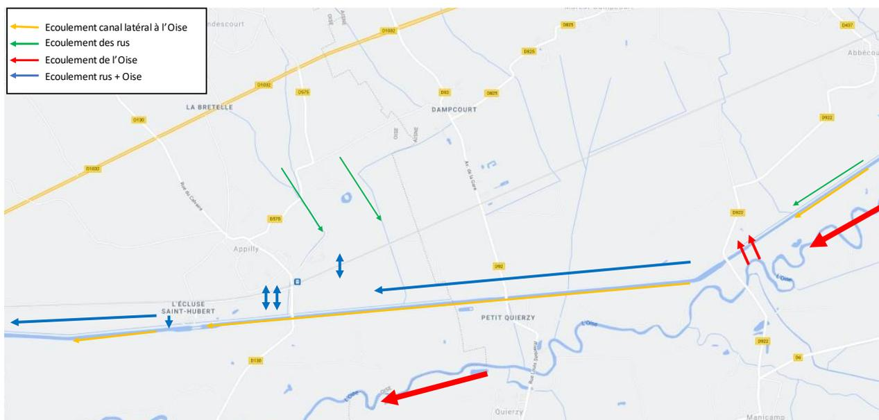
Figure 2 : Récapitulatif des écoulements en rive droite lors d'une crue de l'Oise sans aucune action de réduction des inondations, fond cartographique Google map
